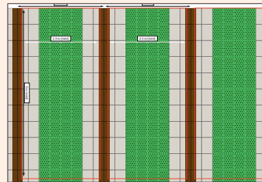
Kombination Pflanzen + Pflastersteine Senkrechtaufstellung
