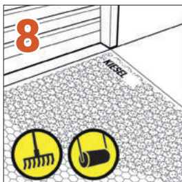
Befüllen und Abschlusarbeiten. Schotter Typ 5/15 oder 8/16.
