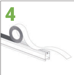
Verlegung des Anti-Kondensationsbands.
